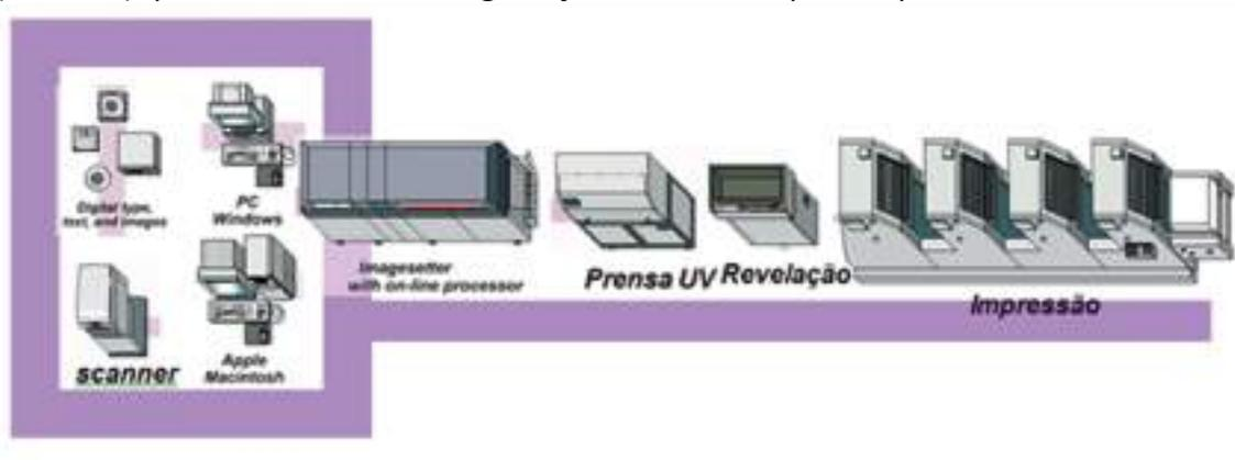
O fluxo baseado em filme requer controlo muito refinado dos processos de gravação de filme pelo *image setter*, revelação química dos filmes, cópia e revelação de chapas.
