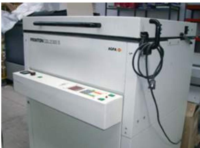
O contacto fotográfico é realizado sempre camada com camada, de modo que não haja interferência da espessura do suporte de poliéster durante a exposição. Após a exposição do material virgem, os haletos de prata que foram expostos a luz UV se tornam resistentes, gerando uma imagem latente (existente, mas ainda não visível), sendo enegrecidos pelo revelador. As áreas não expostas são eliminadas no processo de revelação e fixação.
