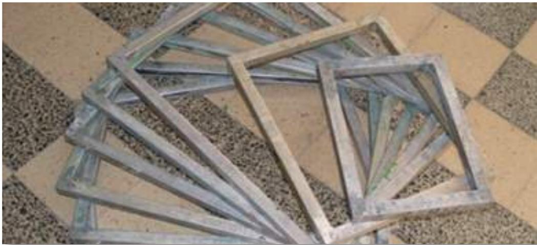
Estes quadros podem ter suas hastes parafusadas ou soldadas, sendo que isso não provocará diferenças na impressão, e suas hastes geralmente são ocas por dentro, ajudando desta forma na redução da massa do quadro, sendo que facilitará no manuseio da forma.
